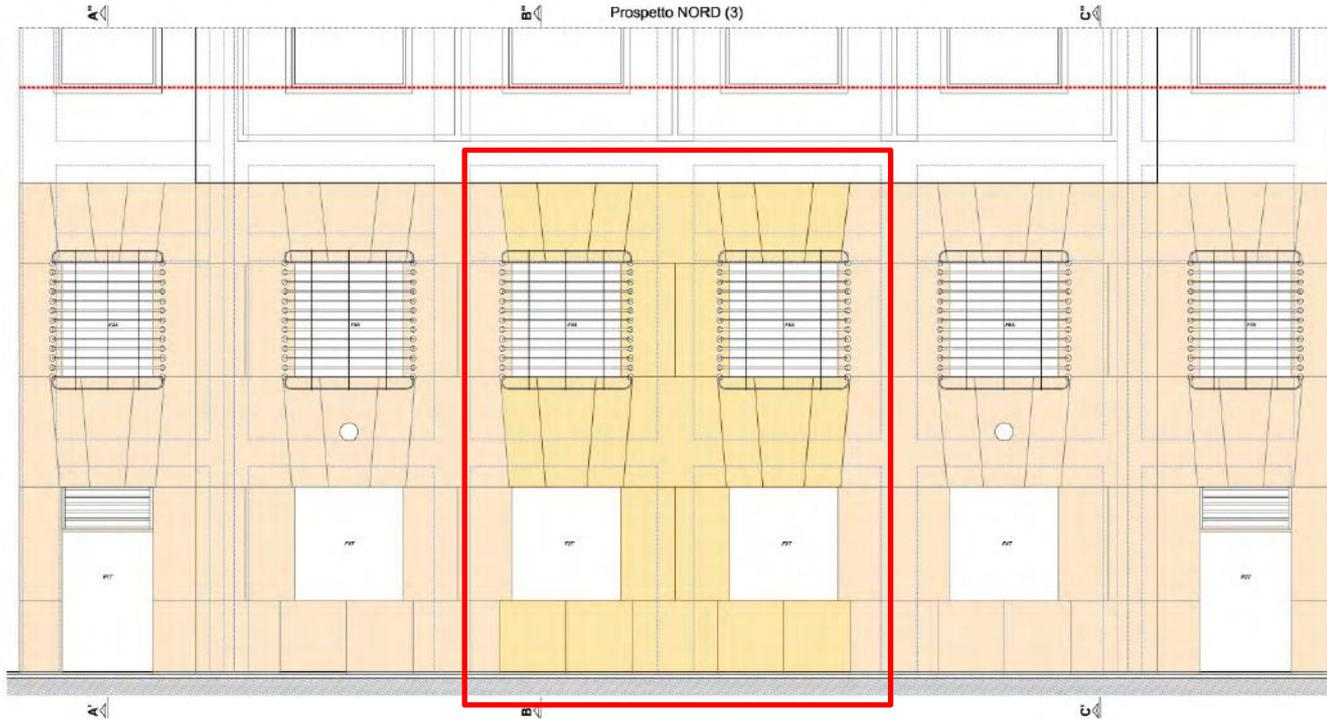
I dati ottenuti dalla fase di indagine, con meno del 40% delle lastre integre, ha condotto a prevedere la sostituzione integrale del rivestimento
